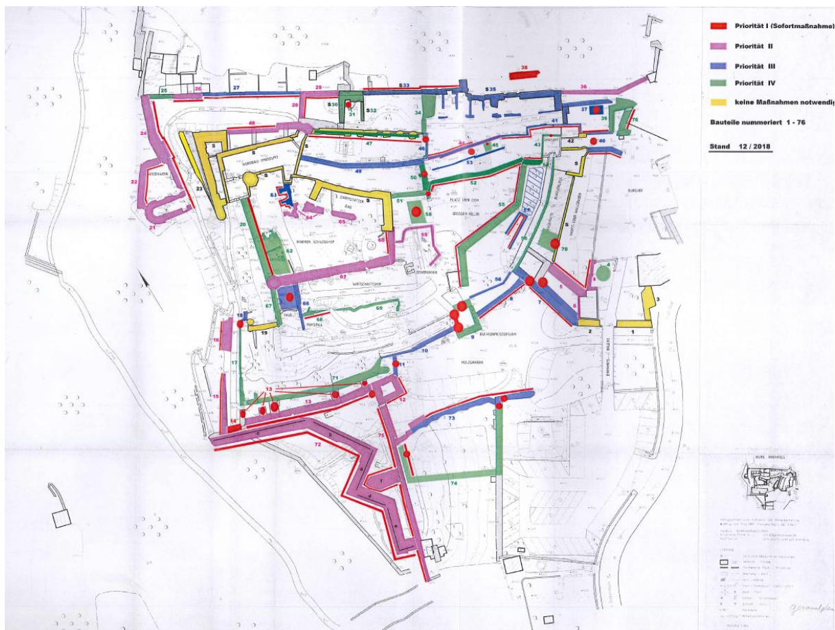
Ausschnitt Maßnahmenplan zur Sanierung der Burg Rheinfels 11
